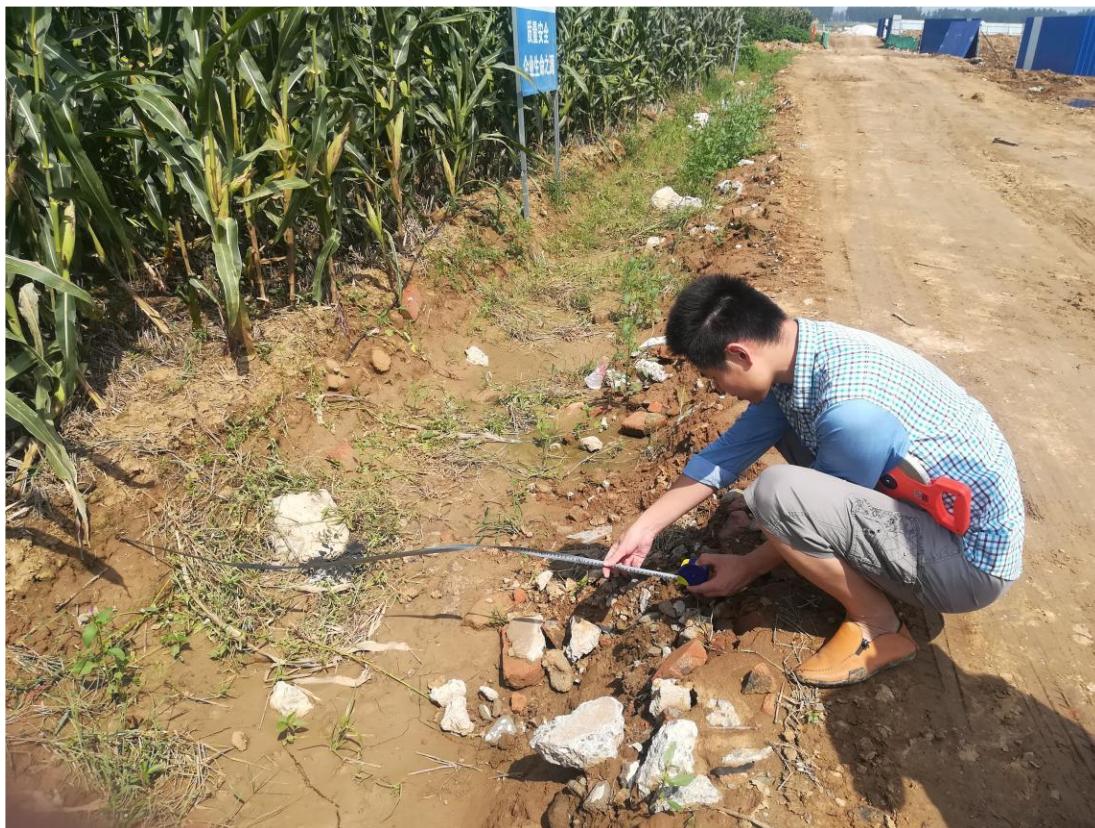
照片 1.9 临时排水沟尺寸监测
